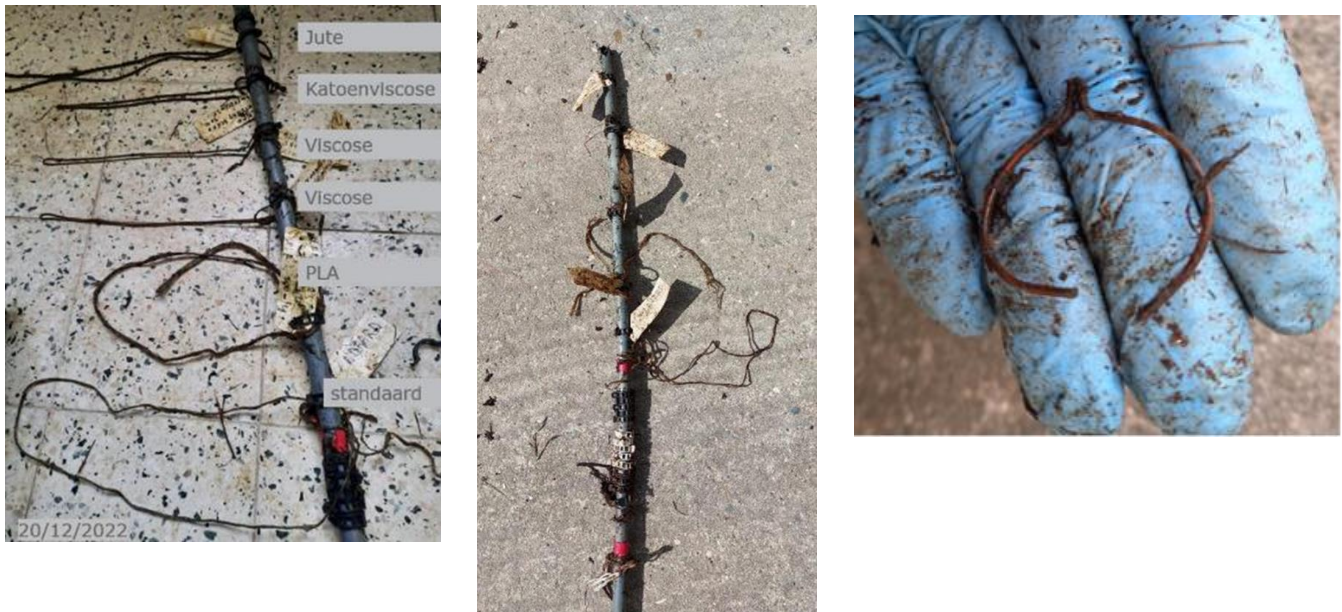
Figuur 6: Resultaten van de testen van verschillende materialen clipsen en touwen in een boerderijcomposteringsproces. (Links) Opstelling van de verschillende soorten touwen voordat deze gecomposteerd werden. (Midden) Opstelling van de verschillende soorten touwen nadat deze gecomposteerd werden. (Rechts) Metalen clips waarbij tekenen van afbraak te zien zijn.
